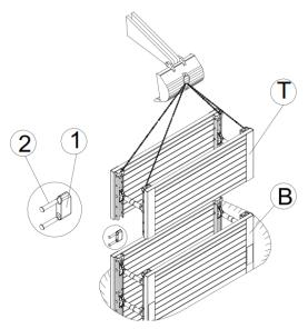
En fonction de la profondeur de tranchée, le caisson de réhausse (T) sera accouplé au caisson de base (B) à l'aide de pièces de fixation (1) et d'axes (2). Utiliser ici aussi des enclumes pour la poursuite de la descente par havage.
