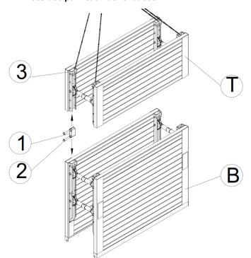
Lors de la mise en place après excavation, l'assemblage du module de base (B) et du module de rehausse (T) doit être réalisé en dehors de la tranchée.
