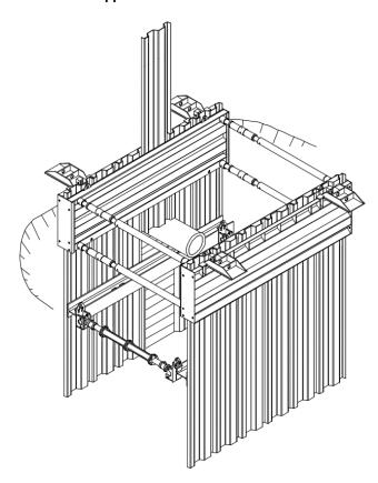
Après la mise en place des palfeuilles est réalisée la descente en alternance avec l'excavation.
