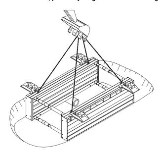
Après le mesurage de l'alignement de la tranchée l'excavation pour la pose du panneau guide palfeuilles peut commencer.
