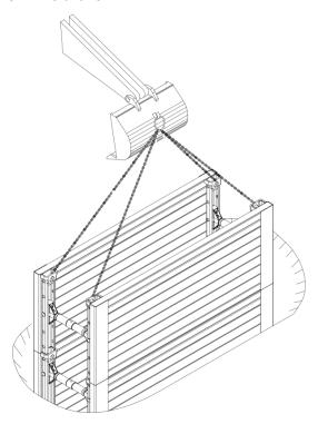
Mettre en place le système de blindage préparé en dehors de la tranchée dans la tranchée creusée complètement jusqu'à la profondeur finale pour la longueur et la largeur d'un caisson de blindage au moyen d'un engin de levage et d'un moyen de levage adapté (homologation GS).
