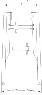
Avant la mise en place des caissons, l'ouverture des vérins devra se faire de telle manière que la distance entre les panneaux du caisson soit plus importante en bas qu'en haut. Cette forme en A est obtenue en ouvrant le vérin du bas d'environ 20mm par mètre de hauteur de caisson.
