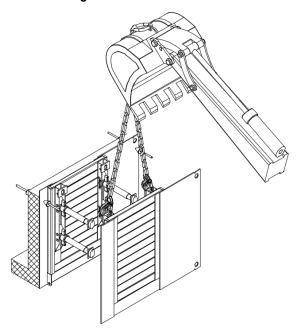
À l'aide d'un dispositif de levage, rapprocher ensuite la deuxième moitié de panneau de la moitié de panneau déjà redressée à la verticale et sécurisée, et fixer comme au point 1.
