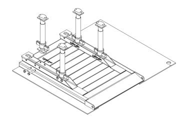
Positionner d'abord le blindage de compensation de longueur KRINGS LAV sur une surface plane et suffisamment stable.
