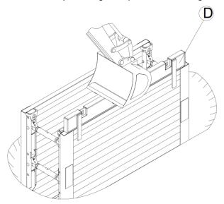
La descente se fait au fur et à mesure de l'excavation des terres.
