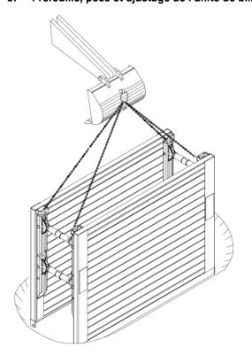
L'excavation pour la pose de la première unité de blindage est réalisée après la détermination de l'alignement. Poser et aligner le blindage et aligner de manière centrée et parallèle à l'axe de tranchée au moyen d'un engin de levage et d'un moyen de levage (homologation GS, anneaux d'ancrage).
