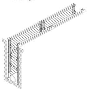
Les travaux de pose de tuyaux peuvent commencer dès que le blindage est descendu complètement et de manière jointive jusqu'au fond de la tranchée sur la longueur souhaitée.
