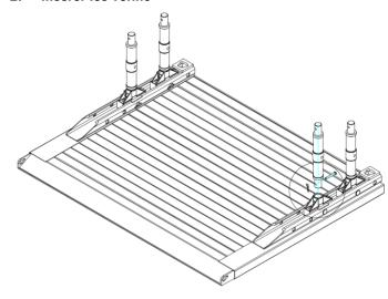
Insérer les vérins dans les champignons ressort, introduire les axes et bloquer à l'aide des épingles de sécurité. (voir le détail X).
