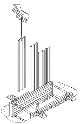
À présent, les palfeuilles peuvent être insérées entre les parois des panneaux du guide et pressées dans le sol avec le godet de l'excavatrice.
